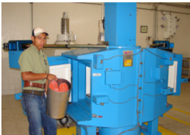
Fig. 1: Irradiador de Cobalto-60 utilizado para la esterilización de mosca del Mediterráneo (Fuente: Programa Moscamed Guatemala).
