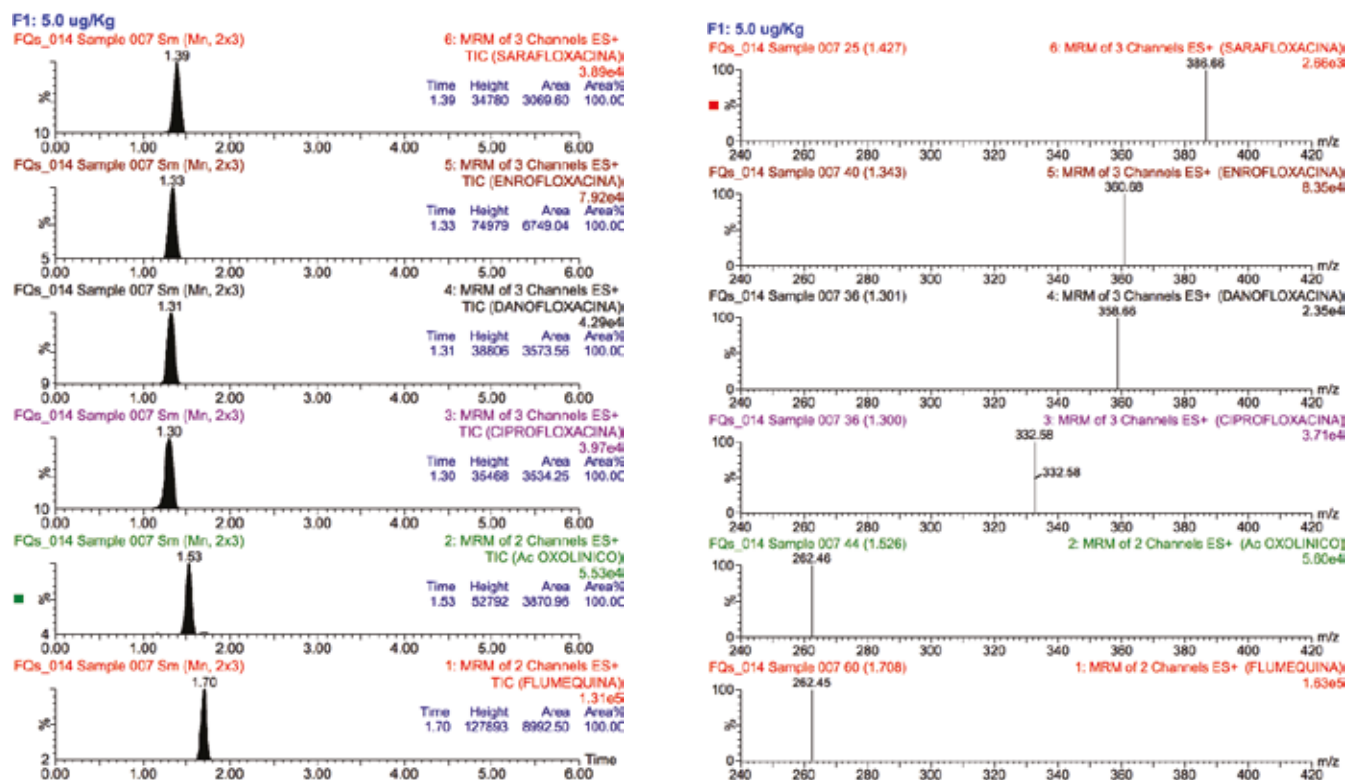
Figura 2. Cromatograma y Espectro de masas para Fluoroquinolonas; SAR, ENR, DAN, CIP, OXO, FLU en matriz de músculo de camarón fortificado a 5 \mu\text{gkg}^{-1} .
